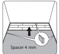
**Die letzte Reihe** muss mindestens 5 cm breit sein. Messen Sie die Diele aus und schneiden Sie sie zurecht. Lassen Sie einen 4 mm breiten Spalt zur Wand hin. Schneiden Sie den nicht benötigten Teil mit der Aluminiumleiste (der Länge nach) ab. Verlegen Sie die zugeschnittene Diele.
