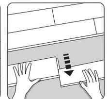
**ACHTUNG:** Um eine Beschädigung des Verriegelungssystems zu vermeiden, müssen die Dielen beim Trennen stets nach oben gebogen werden.
