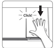
Nach dem Verlegen von 3 kompletten Reihen, schieben Sie den Fußboden zur Wand hin. Lassen Sie einen 4 mm breiten Spalt und verwenden Sie die Abstandhalter! Ist die Wand uneben, müssen die Dielen der ersten Reihe an deren Konturen angepasst werden.
