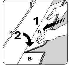
Die Stirnseiten durch Klopfen mit der Faust (oder Schlagklotz, Gummihammer) verriegeln, dabei von Innen nach Außen arbeiten.
